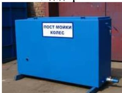
Предназначена для работы в особо стесненных условиях с ограниченной пропускной способностью до 5 машин в час. Оснащена одним моющим пистолетом. Выпускается в двух вариантах рабочего напряжения: 380В и 220В. Комплект "Мойдодыр-К-1" состоит из очистной установки, капсулы (рекомендуется выплнить бетонный приямок), погружного насоса, моечного насоса, одного пистолета, печки для обогрева насосного отсека и типовой технологической схемы организации моечного поста из дорожных плит.
